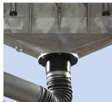
Specialkonsol med flange ø160 - ø200mm for slæde- kanal type SSK og bord- montage.
