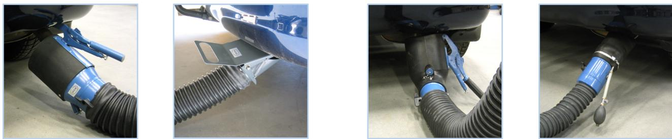
Les entonnoirs d'échappement Gram sont livrés pour toutes les marques de voitures standard et spéciales. Fabriqué en acier et acier revêtu de caoutchouc résistant à la température.
