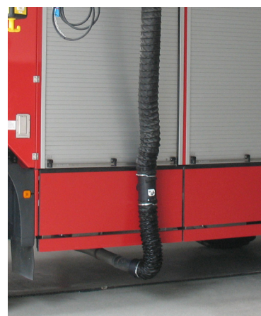
Embout d'échappement à connexion magnétique dans un tuyau suspendu.
