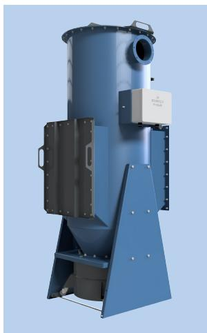
Kompakte druckluftgereingte Filteranlage für kleinere Filteraufgaben, wo ein Risiko für Staubexplosionen besteht, z.B. bei Filterung von Metallstaub, Holzstaub oder Staub aus der Handhabe mit verschiedenen Pulvermixen. Anlage für Anwendung bei ATEX-Zonen 21-22 konstruiert und Standard mit Berstscheibe ausgestattet, die dafür vorgesehen ist, bei einer Explosion zu bersten, wobei Anlage entlastet wird, und Explosionen kontrolliert werden.
