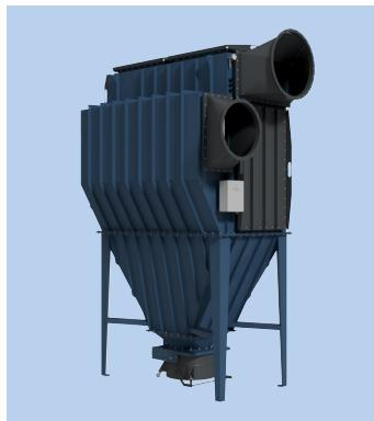
Energieoptimierte Anlage für grössere Filteraufgaben. Wird zur Filterung von Schleifstaub, Strahlmittelstaub, Schneiderauch und staubiger Luft mit Metall, Stein, Kunststoff usw. oder von der Handhabe verschiedener Pulvermixe angewandt. Anlage für Anwendung bei ATEX-Zonen 21-22 konstruiert und Standard mit Berstscheibe ausgestattet, die dafür vorgesehen ist, bei einer Explosion zu bersten, wobei Anlage entlastet wird, und Explosionen kontrolliert werden.
