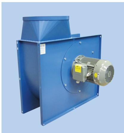
Hochtemperatur-Zentrifugalventilator mit geschlossenem Ventilatorrad, der für Punktabsaugung von verschmutzenden oder späneerzeugenden Arbeitsprozessen angewandt wird. Transportierte Luft darf nicht klebende oder klebrige Dämpfe oder Staub enthalten.
