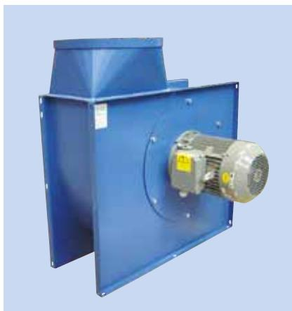
Ventilateur centrifuge haute température à roue fermée utilisé pour l'extraction à la source de l'air pollué ou des processus de fabrication de copeaux. L'air transporté ne doit pas contenir de fumées ou de poussières adhésives ou collantes.
