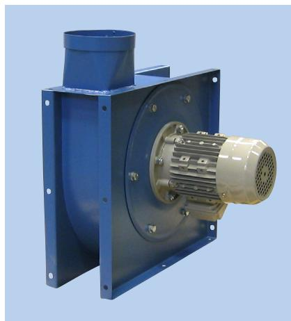
Ventilateur centrifuge à roue ouverte utilisé pour l'extraction à la source de l'air pollué ou des processus de fabrication de copeaux. L'air transporté ne doit pas contenir de fumées ou de poussières adhésives ou collantes.
