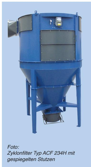
Energieoptimierte Anlage für größere Filtrierungsaufgaben. Wird zur Filtrierung von Schweißrauch, Schleifstaub, Schneidrauch und metall-, stein- und kunststoff-haltiger Staub in der Luft oder von der Handhabe von unterschiedlichen Pulvermix angewandt.
