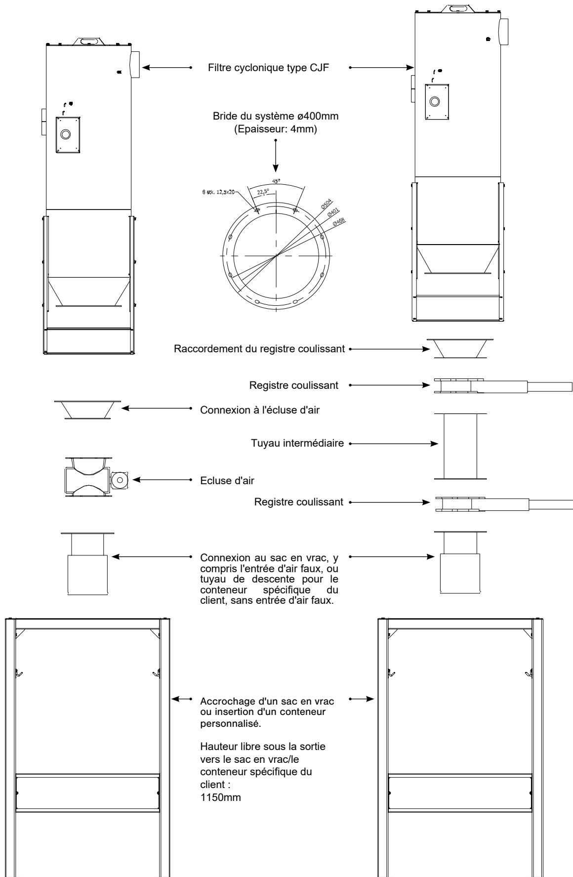
Le filtre cyclone de type CJF/CJF-V/CJF-HV est disponible dans les tailles indiquées dans les tableaux ci-dessous. Le CJF-V et le CJF-HV sont destinés aux utilisations à haute pression.
