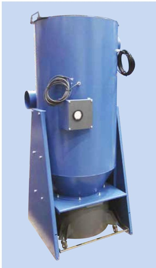
Unité compacte de filtration à nettoyage par air comprimé avec commande par minuterie pour la filtration des fumées de soudage, des poussières de meulage, des fumées de coupe et de l'air poussiéreux contenant du métal, de la roche, du plastique, etc. ou provenant de la manipulation de divers mélanges de poudre.
