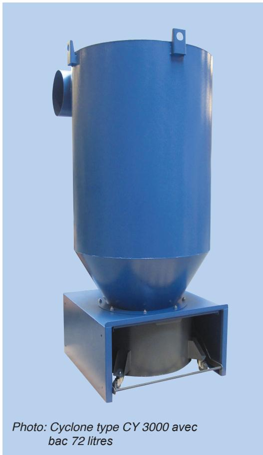
Comme séparateur grossier avant les unités de filtration ou comme protection des ventilateurs, vous pouvez avantageusement utiliser un cyclone de type CY. Pour la haut pression, le modèle CY-V peut être utilisé et pour la pré-séparation des matériaux légers, le LCY avec une séparation élevée/une faible vitesse de montée est recommandé.
