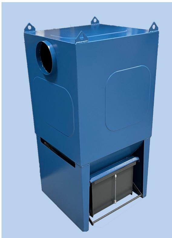
Wird als Vorabscheider vor Filterung der Prozeßluft angewandt, die eventuell Funken beinhaltet, welches der Fall sein kann, wenn es ein relativ kurzer Weg vom funkenerzeugenden Prozeß, z.B. Schleifen, Plasma- oder Brennschneiden, bis zur Filteranlage ist. Im Vorabscheider mit Funkenfang Typ FUV werden mögliche Funken durch Labyrinth mit Wasser erlöschts.
