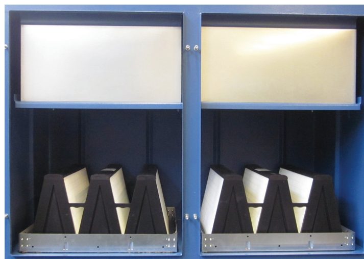
Foto oben: Ölnebelabscheider Typ OUK ist auch mit zusätzlicher Filtrierungsstufe durch HEPA-Schwebstofffilter (oben) erhältlich. Kompaktfilter ist unten ersichtlich.
