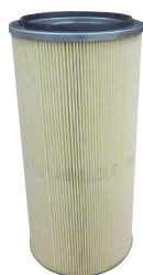
Cartouche La filtration fine à travers des cartouches filtrantes auto-drainantes augmente l'intervalle entre les remplacements de filtres nécessaires. (Durée de vie normale 2000-6000 heures)
