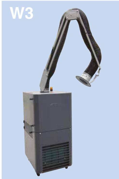
Unité de filtration efficace et mobile avec nettoyage automatique par air comprimé avec ventilateur intégré qui est utilisée pour la filtration de l'air des processus qui forment des quantités limitées de poussière (soudage, découpage, meulage et autres).
