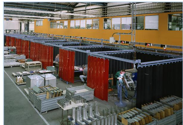
Zum Aufbau und Abschirmung von Arbeitsplätzen ist ein komplettes Programm von Komponenten zum Aufbau von Schweiß- und Schleifkabinen in 40 x 40 x 2,5mm verzinktem C-Profil (siehe nächste Seite) erhältlich.
