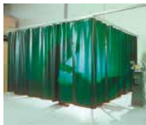
Eksempel på kabineopbygning med grønt svejsesforhæng og C-profiler.
