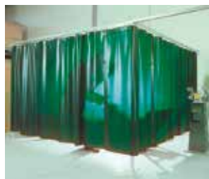
Beispiel eines Kabinenaufbaus mit grünem Schweißvorhang und C-Profilen.
