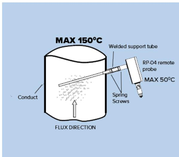
Die Zeichnung auf der linken Seite zeigt, wie die Sonde in den Rücklaufkanal eingebaut wird
