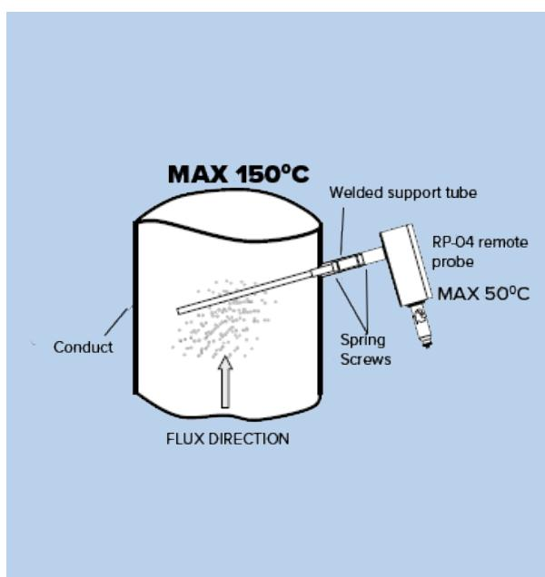
**Le dessin de gauche montre comment installer la sonde dans le conduit de sortie.**
