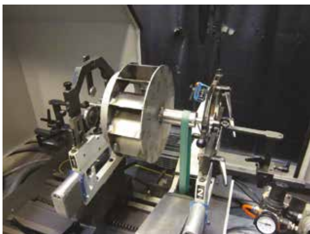
Ventilatorhjul i afbalanceringsmaskine
